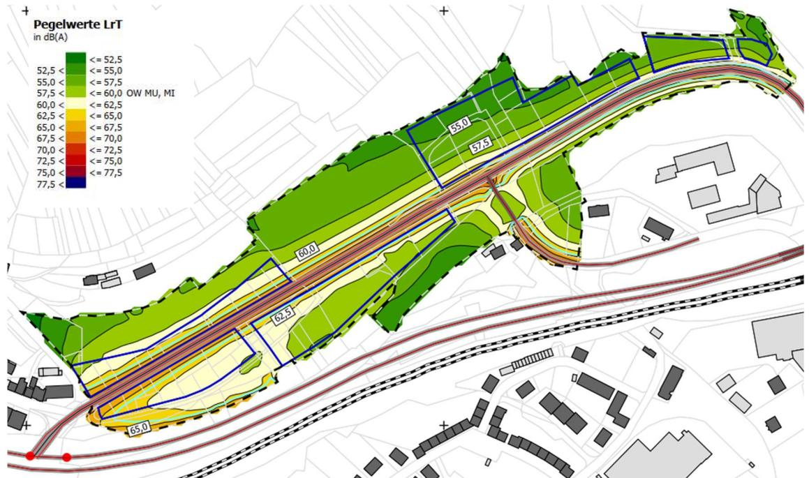
Die Fassadenpegel der Gebäude im Nordosten Plangebiets (vgl. Abbildung 10 (A06)) liegen unter dem Orientierungswert. An Gebäuden in den drei westlichen Baufenstern sowie an Gebäuden in der Nähe der Hauptstraße treten Beurteilungspegel von mehr als 60 dB(A), bis maximal 67 dB(A) auf.
