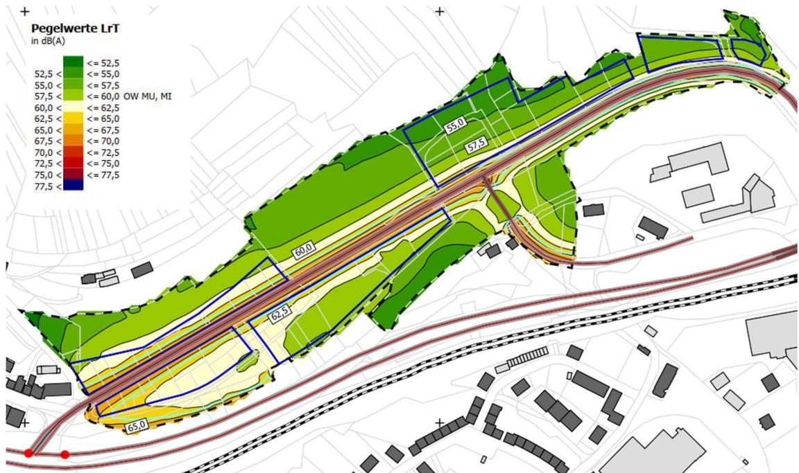
Die Fassadenpegel der Gebäude im Nordosten Plangebiets (vgl. Abbildung 10) liegen unter dem Orientierungswert. An Gebäuden in den drei westlichen Baufenstern sowie an Gebäuden in der Nähe der Hauptstraße treten Beurteilungspegel von mehr als 60 dB(A), bis maximal 67 dB(A) auf.
