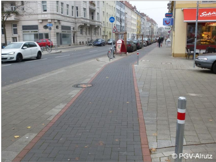
Abb. 5-16: Teilpflasterung im Einmündungsbereich einer Nebenstraße (Hannover)
