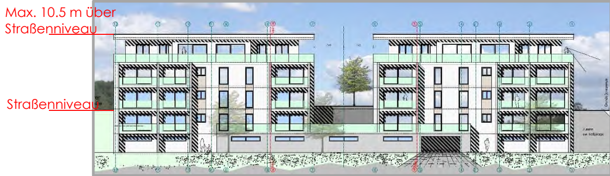
Abb.: Darstellung der hangangepassten Bauweise Rückansicht
