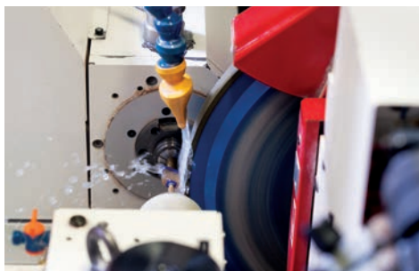
Einblick in die CNC-gesteuerte Bearbeitung von Edelsteinen
